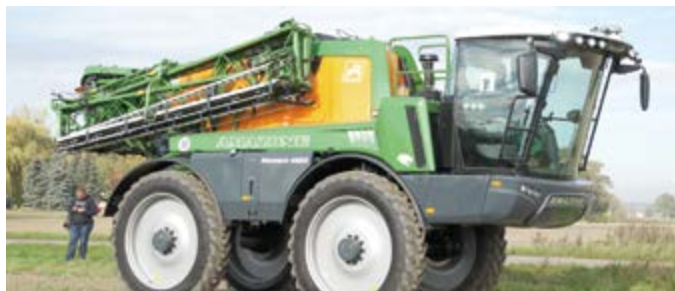
Szerokość robocza opryskiwacza samojezdnego Pantera to aż 40 m
