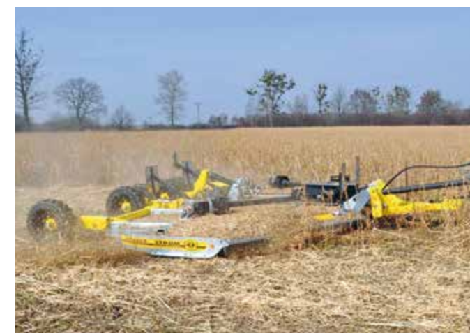
Trójwirnikowy mulcer firmy Bednar o szerokości roboczej od 4,6- 6m
