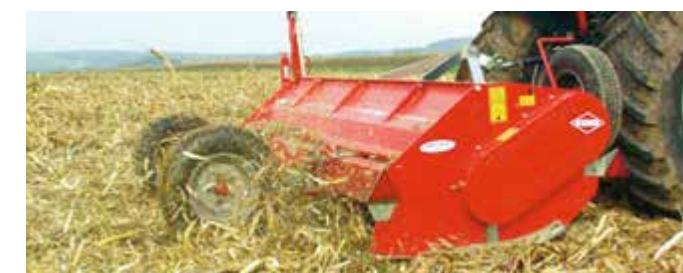
Mulcer Kuhn RM 280 z jednostronnym napędem na 1 rotor
