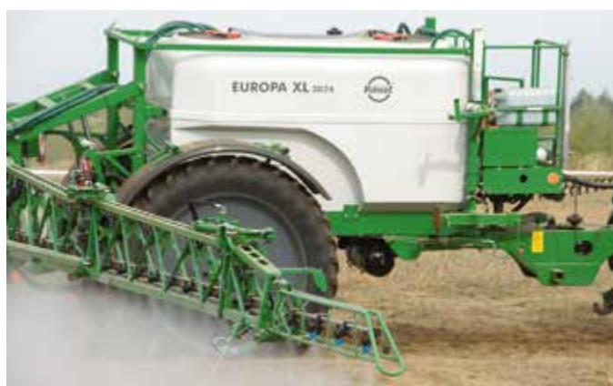
Opryskiwacz Europa 3024, wyposażony w automatyczny dyszel śledzący, który umożliwia precyzyjne kopiowanie śladów ciągnika w uprawach rządowych
