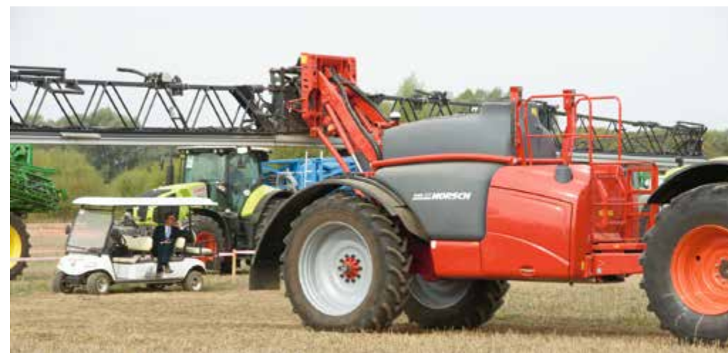
Opryskiwacz Horsch Leeb 5LT posiada zbiornik plastikowy, który stanowi alternatywę zbiorników ze stali kwasoodpornej, stosowanych w innych opryskiwaczach niemieckiej firmy
