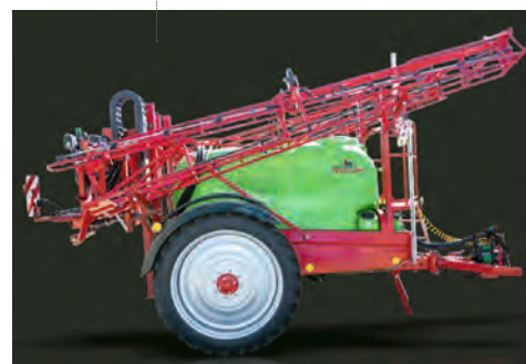
Krukowiak - umieszczenie opraw rozpylaczy co 50 cm, umożliwia szybką wymianę samych rozpylaczy
