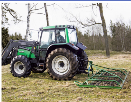
Brona ławkowa 4 m 36-BH400 Sekcje 3 Trzypunkt. układ zawieszenia Kat. 2 Masa 310 kg DOSTĘPNE INNE SZEROKOŚCI 3.390 zł
