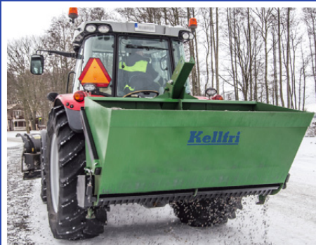
Piaskarka 2,1 m z siłownikiem i wężem 32-S1250C Pojemność zbiornika 1250 l Szerokość całkowita 2250 mm Masa 522 kg 8.990 zł
