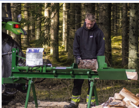
Łuparka z napędem z ciągnika rolniczego 13-VK700 Wysokość robocza 720 mm Siła nacisku 7 ton Masa 144 kg 2.090 zł
