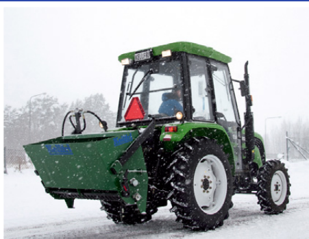
Piaskarka 1,3 m z siłownikiem i wężem 32-S350C Pojemność zbiornika 350 l Szerokość całkowita 1450 mm Masa 322 kg 5.990 zł
