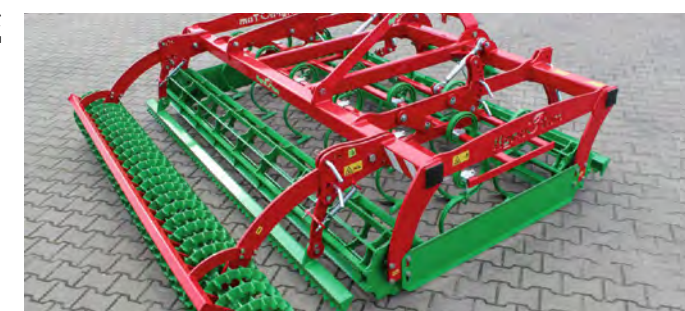
Agregat uprawowy UP z AgroTomu. Producent wyposażył go w dwa wały płaskownikowe lub rurowe oraz tylny crosskill z możliwością podwójnej sekcji roboczej
