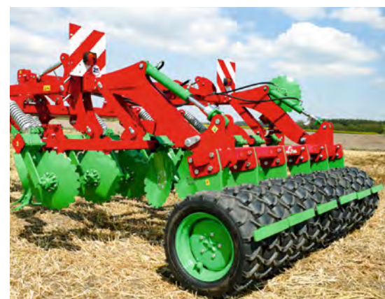
Wał oponowy stosowany jest najczęściej przy większych agregatach uprawowych lub uprawowo-siewnych
