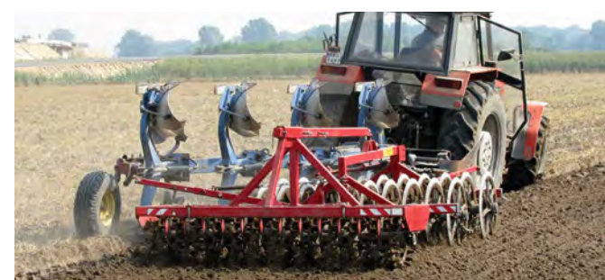
Wał Cambella stosuje się głównie po orce w celu szybszego osiadania gleby. Na zdjęciu zestaw wałów Cambella z doprawiającym wałem crosskill
