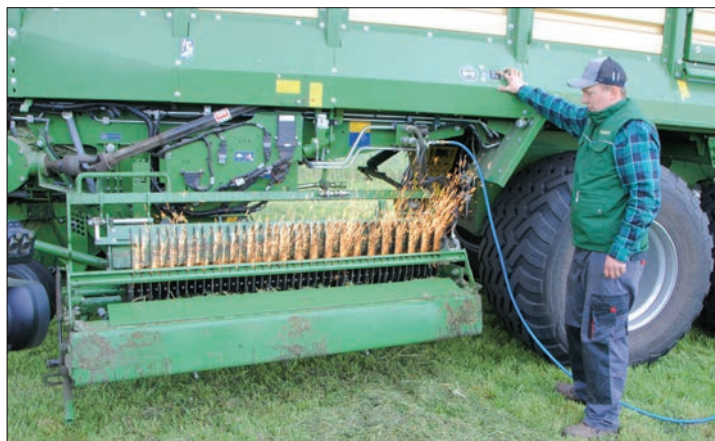
Nowa przyczepa zbierająca Krone wyposażona jest w ostrzałkę noży
