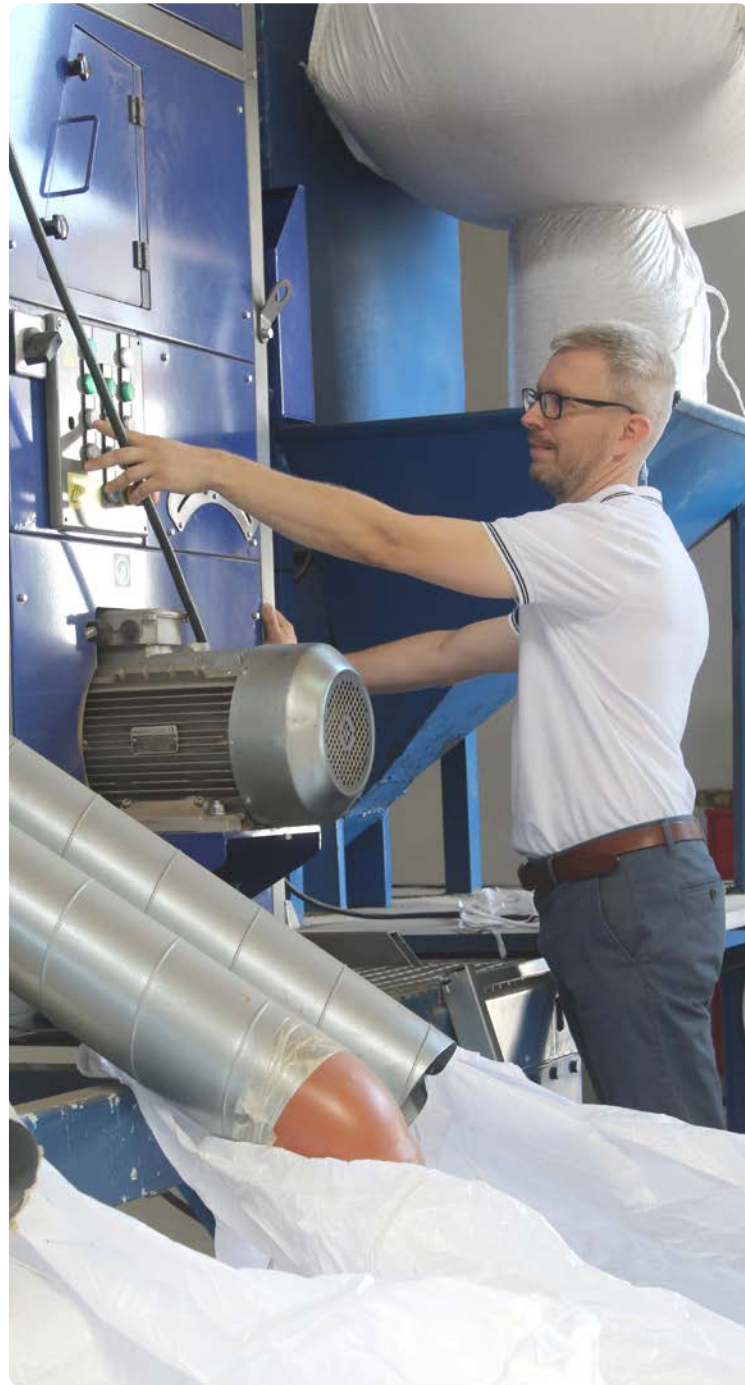
▲ Separator aerodynamiczny w Nagardowicach służy głównie do czyszczenia nasion roślin bobowatych
