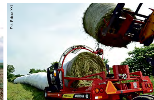
Anderson - Przy szeregowym owijaniu balotów jedynym czynnikiem ograniczającym jest miejsce
