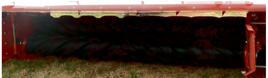
Walce zgniatacza, wykonane z gumy, idealnie nadają się do zdzierania warstwy woskowej z roślin motylkowych
