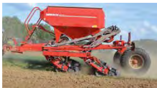
Siewnik Avatar 6 SD, maszyna zaprezentowana na Agritechnice 2015, przeznaczony do siewu bezpośredniego, wyposażony w dwa rzędy redlic jednotarczowych
