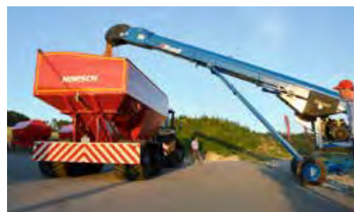
Naczepa przeładunkowa Titan 34UW, o pojemności 34 metrów sześciennych, błyskawicznie ładowana (bezpośrednio z silosa), przez przenośnik Brandt
