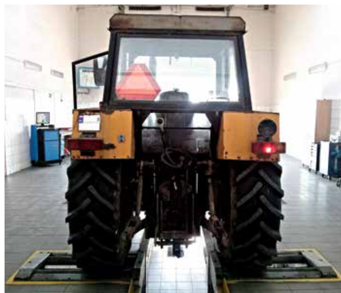
Brak pełnego oświetlenia, brak prawego lustra oraz zły stan karoserii - to usterki wykryte na badaniu okresowym
