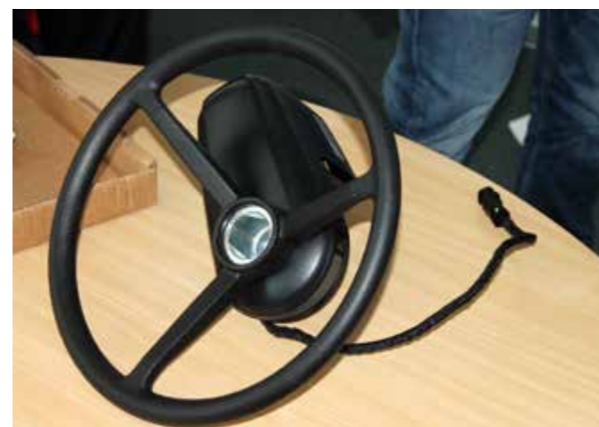
Elektryczna kierownica zdejmująca z operatora obowiązek manewrowania po polu. Kierowca może regulować parametry pracy i kontrolować jej przebieg
