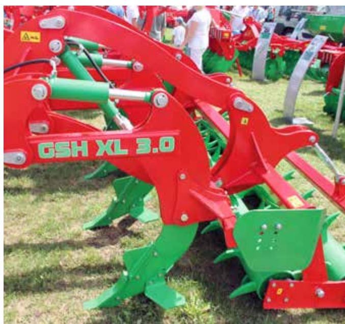
Hydrauliczne zabezpieczenie na kamienie
