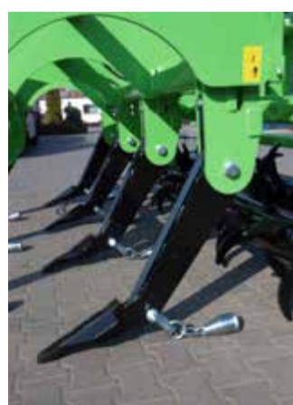
Fot. Bomet Kret drenuje glebę. Jest on szczególnie przydatny, gdy gleba nie magazynuje wody (tzn. przepuszcza ją) lub gdy woda nie chce w nią wsiąkać
