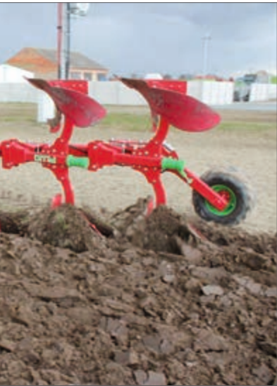
Fantom firmy Pneusej wykonuje kilka uprawek przy jednym przejeździe
