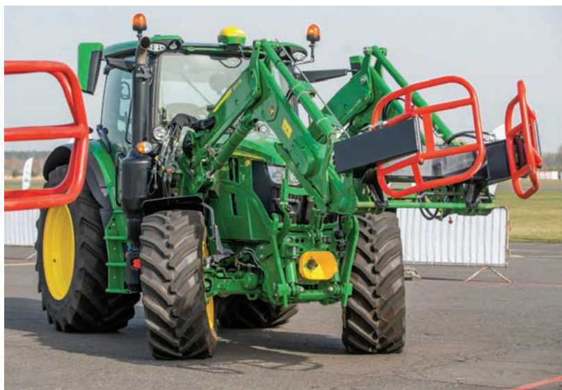
John Deere 6R świetnie sprawdzi się w pracy z ładowaczem czołowym, który został wyposażony w nowe funkcje m.in. ważenie dynamiczne
