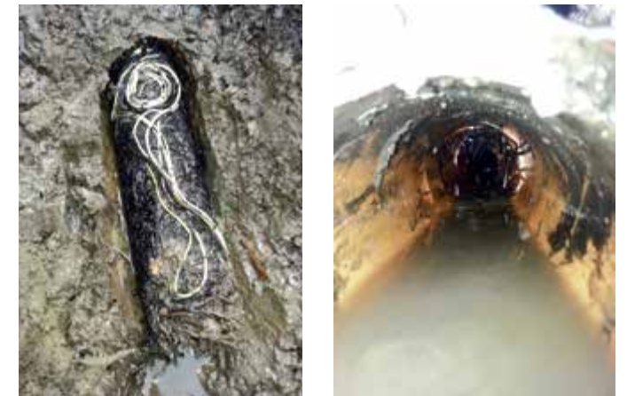
Największym zagrożeniem dla drenów są lata suche, kiedy głęboko sięgające korzenie zatykają ich otwory
