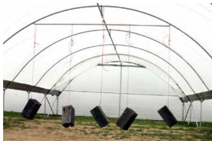
Test wytrzymałościowy konstrukcji - wiszące pustaki o wadze 75 kg
