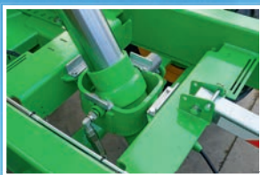
Przegub siłownika wywrotki z podwójną osią obrotu
