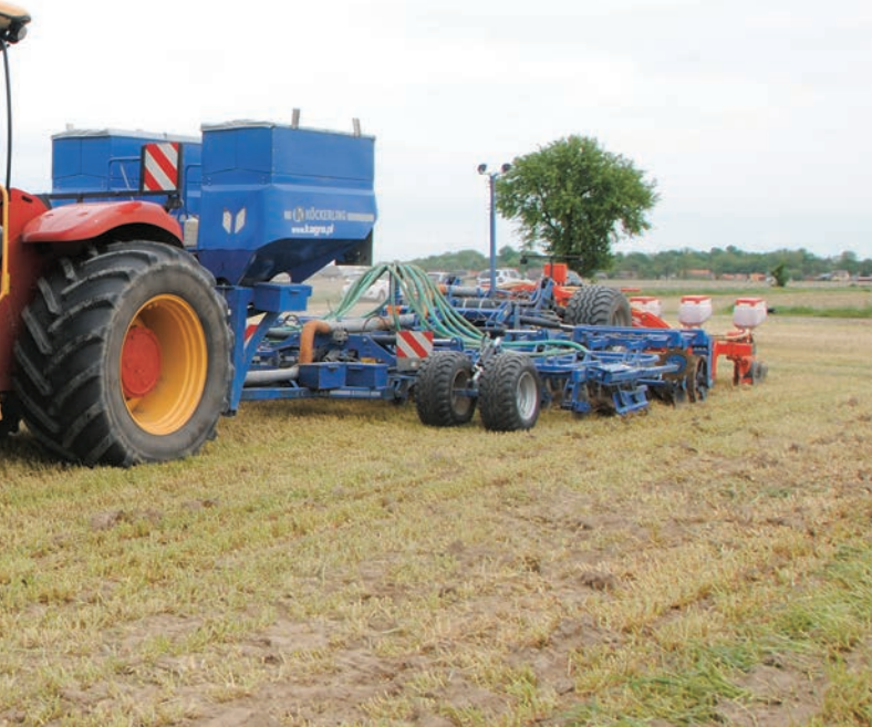
Ciągnik przegubowy Versatile z zestawem maszyn do uprawy w systemie Strip Till
