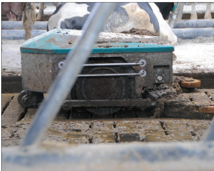
Robot do zgarniania obornika z rusztów jest urządzeniem praktycznie bezobsługowym
