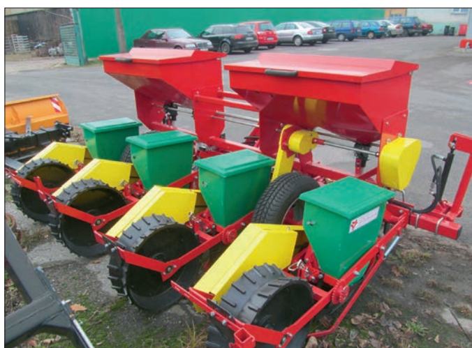
Siewnik Meprozet S100 posiada 4 sekcje oddalone od siebie w odległości 60-80cm
