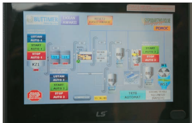
Dotykowy ekran, którym obsługuje się pracę czyszczalni
