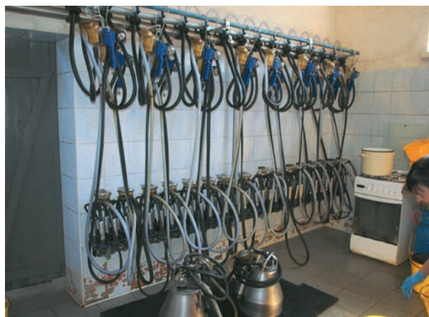
Dojarka rurociągową na 16 stanowisk
