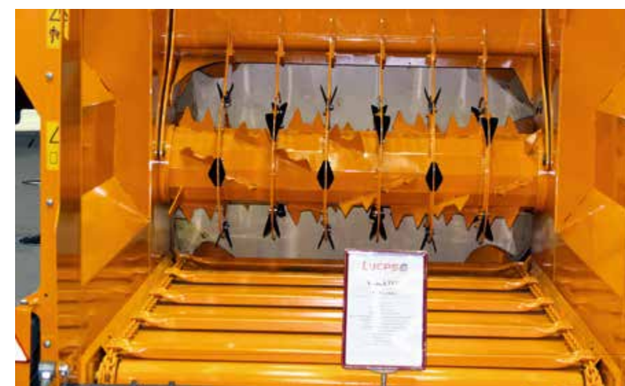
Bęben rozdzielający z nożami tnącymi
