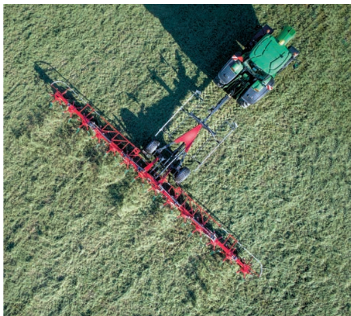
Największy z przetrząsaczy marki Kverneland ma szerokość roboczą 13,3 m
