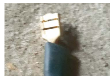
Cynowanie końcówek eliminuje efekt śnieżenia, a osłona z PCW zwiększa odporność na odkształcanie mechaniczne
