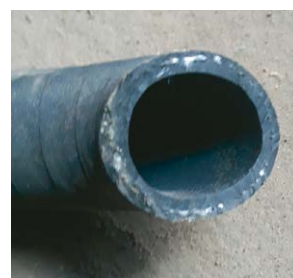
Dodatkowe zbrojenie nie zmusza do częstych wymian przewodów układu chłodzenia
