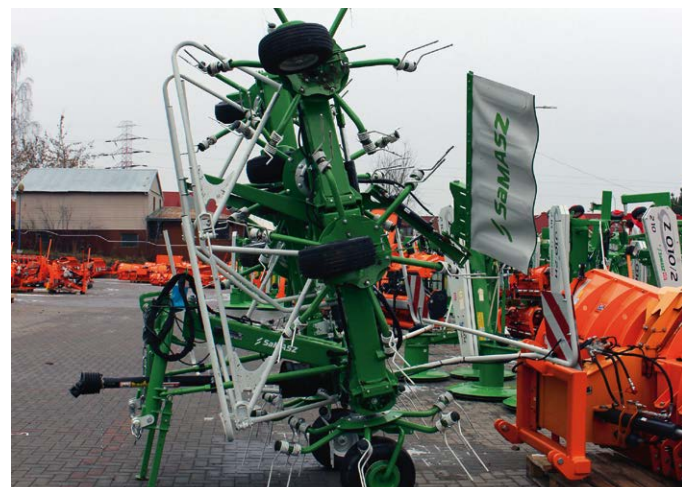
Najnowszy produkt SaMASZ-u jest na etapie prac badawczo-rozwojowych, w fazie testowania. To linia dwóch przetrząsaczy ośmiokaruzelowych do średnich i dużych gospodarstw
